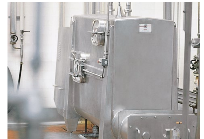
IMPIANTO OMOGENEIZZAZIONE BURRO BUTTER HOMOGENISER
