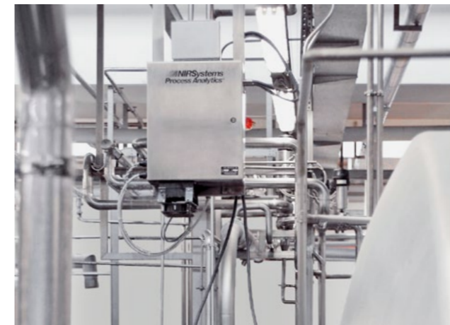
SISTEMA DI CONTROLLO IN LINEA NIRSystem (PARAMETRI LEGALI) NIRS IN-LINE MONITORING SYSTEM (LEGAL PARAMETERS)
